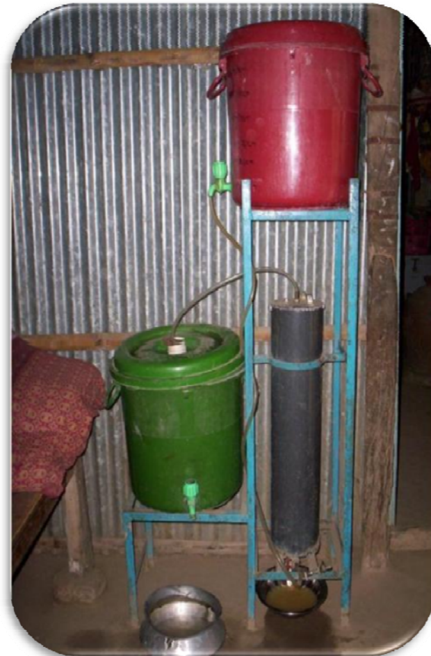
Kućni filter za uklanjanje arsena
